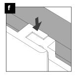
Instalar el siguiente panel en el extremo opuesto del primer panel. El paso F se repite según la cantidad de paneles a instalar.
