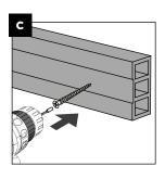
Una vez marcada su ubicación, atornille con tornillo de acero inoxidable a la superficie los bastidores bases para fijar en la pared.
