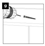
Coloque los tornillos en la parte superior de la cubierta lateral para fijarlos.
