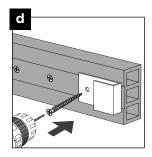
Atornille la hebilla con tornillo de acero inoxidable que quede instalado justo al extremo de los bastidores bases.
