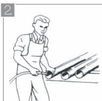
2. Limpiar la tubería antes de usarla. La suciedad de las tuberías puede causar problemas al sistema.
