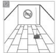
Limpie el piso en seco, con una escoba de cerdas suaves. En caso de que la obra no se entregue inmediatamente, recubra los pisos con una capa de tiras de polietileno y dos de cartón corrugado para protegerlo de rayones, manchas o golpes. No se deben instalar elementos que fijen el piso al contrapiso como paredes de drywall, topes de puertas, zócalos rodones clavados al piso, etc.
