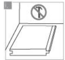
Instale el piso Power Wood de manera tal que sus bordes 'hembra' apunten hacia la esquina en la que inicia la colocación. No las fije a la superficie de soporte con tornillos, clavos ni pegamento, ya que esto impedirá su dilatación y podrá generar agrietamientos o levantamientos de las piezas. Los pisos no se deben instalar sobre superficies alfombradas.
