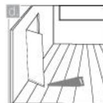
Los pisos laminados pueden obstruir la apertura de las puertas previamente instaladas. Si este es su caso, le recomendamos que corte la parte inferior de las mismas para incrementar la altura con respecto al piso. Realice el mismo procedimiento en la parte inferior de los marcos de madera de las puertas, de manera tal que sea posible deslizar las piezas por debajo de los mismos.
