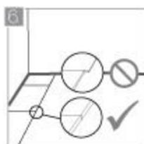
Repita este procedimiento hasta crear una columna de piezas que vaya de un lado a otro de la habitación. Dicha línea debe estar unida por su lado más angosto y no debe presentar separaciones en los puntos de acople, ni diferencias de alineación en sus bordes.
