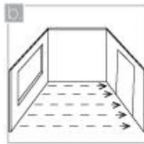
La superficie sobre la que se instalarán los pisos debe estar completamente nivelada. Las diferencias de planitud superiores a los  $\pm$  2mm. de profundidad por metro lineal deben corregirse.
