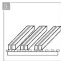
Almacene las cajas de piso en un sitio seco. Manténgalas cerradas, en posición horizontal y preferiblemente sobre un pallet con una separación de al menos 4" con respecto al suelo. No almacene en sótanos o ambientes sin cerramientos de puerta y ventanas.
