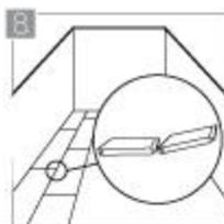
Repita los pasos anteriores para crear una 2a línea de laminados y únala a la primera por su lado más largo, inclinandola en un ángulo de 12° a 25° y empujando hacia adentro y hacia abajo. Repita estos pasos hasta recubrir toda la superficie del piso.
