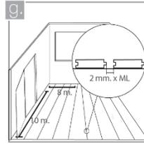
En espacios amplios, instale las maderas en secciones de máximo 80 m<sup>2</sup>, dejando una dilatación de 2 mm. por cada metro lineal entre cada una de ellas.
