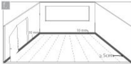
Mantenga una distancia de  $19 \pm 1$  mm entre los pisos y los bordes de todas las paredes, columnas y muebles fijos para permitir que la madera se dilate normalmente y determine cuántas líneas de laminado se requerirán para recubrir la superficie. Es posible que al final del ambiente haya un espacio inferior al ancho de las piezas.
