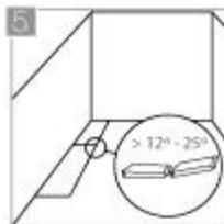
Determine en qué esquina iniciará la instalación y ubique la primera pieza con la cara vista hacia arriba. Inserte la 2da pieza por el lado más corto, inclinandola en un ángulo de 12° a 25° y empujando suavemente hacia adentro y hacia abajo, hasta que las 2 piezas queden en posición horizontal.
