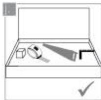
Para la instalación de pisos laminados con sistema de machihembrado es necesario contar con los siguientes elementos: sierra manual o de banco, cuñas de  $19 \pm 1$  mm de espesor, flexómetro, escuadra de carpintería, guarda escobas, martillo, taco golpeador, rollos de polietileno y rollos de espuma.
