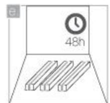
48 horas antes de iniciar la instalación, extienda las cajas en el sitio en que serán colocadas, en posición horizontal y sin desembalar. Esto permitirá que se adapten a las condiciones de humedad del ambiente. La temperatura de trabajo para la colocación debe ser como mínimo 18°C. La humedad relativa del aire (HR) debe ser inferior al 70% antes, durante y después de la colocación.
