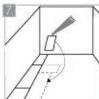
Es posible que la última pieza de la fila sea más larga que el espacio disponible para su colocación. Córtaela transversalmente para adaptarla a la longitud requerida, pero sin ocupar la junta perimetral de  $19 \pm 1$  mm. Si utiliza una sierra manual para este procedimiento, coloque la pieza con la cara vista hacia abajo para evitar daños en su superficie. Utilice el segmento sobrante para iniciar la 2a línea de pisos.
