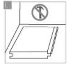
Instale el piso laminado de manera tal que sus bordes 'hembra' apunten hacia la esquina en la que inicia la colocación. No las fije a la superficie de soporte con tornillos, clavos ni pegamento, ya que esto impedirá su dilatación y podrá generar agrietamientos o levantamientos de las piezas. Los pisos laminados no se deben instalar sobre superficies alfombradas.
