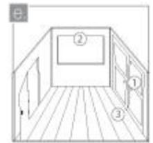
Es importante que la instalación se realice cuando se haya completado todo el servicio de carpintería, servicios eléctricos, hidráulicos y albañilería. Tenga en cuenta que la pintura recién aplicada en las paredes puede elevar los niveles de humedad presente en el ambiente y afectar el aclimatado inicial de las piezas.
