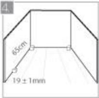
Ponga cuñas de madera de  $19 \pm 1$  mm de espesor en las paredes, alrededor de las columnas y en la base de los muebles fijos. Conserve un espaciado de 65cm entre cuña y cuña. Esto le ayudará a mantener la junta perimetral de  $19 \pm 1$  mm entre los pisos y los límites físicos del ambiente.
