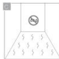
Antes de instalar el piso laminado, asegúrese de que la superficie de soporte haya fraguado completamente y que no presente muestras de humedad. El nivel de humedad de la losa debe ser menor a 4%. En construcción nueva se sugiere la medición de la losa mediante un equipo especializado, para remodelaciones en construcción antigua esta medición es opcional.
