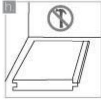
Instale las maderas de manera tal que sus bordes ‘hembra’ queden mirando hacia las paredes. No las fije a la superficie de soporte con tornillos, clavos ni pegamento, ya que esto impedirá su dilatación y podrá generar agrietamientos o levantamientos de las piezas. Los pisos de madera no se deben instalar sobre superficies alfombradas. Estas y cualquier rastro de pegamento deben retirarse antes de iniciar la colocación.
