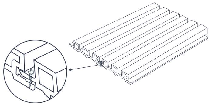
**2-** Alinee el WPC con la base o estructura portante previamente instalada, iniciando por el canal de fijación del WPC.
