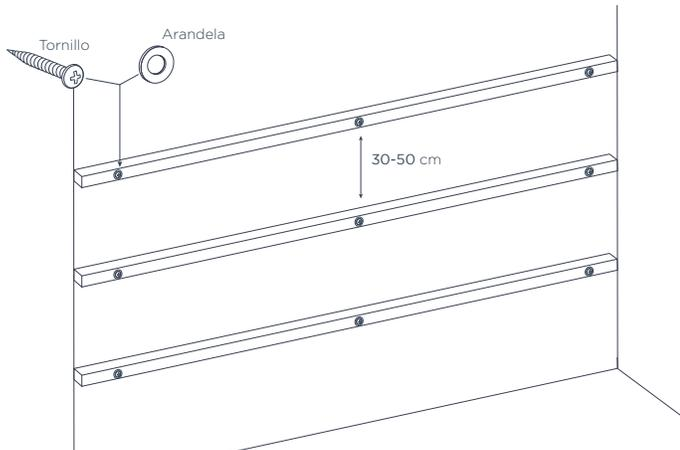
**1-** Instale la estructura con fijaciones y/o apoyos cada **30-50 cm**, perpendiculares a la disposición de la estructura. La perforación debe realizarse con una broca de un tamaño superior a la del cuerpo del tornillo de 2 a 3mm ; Fije el WPC mediante un tornillo de calibre # 12 de 1½ con un chazo tipo arandela, la punta o tipo del mismo dependerá de la materialidad de la base a instalar.
