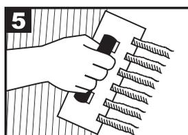
5 Aplique el pegamento con una llana dentada o raspín sobre la superficie a enchapar.
